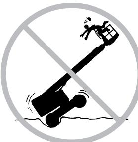
在收起位置下，當機器在不平坦的地形上、有碎石、不穩定或光滑的表面、靠近洞口和陡坡等處行駛時，要極端小心並降低速度。
